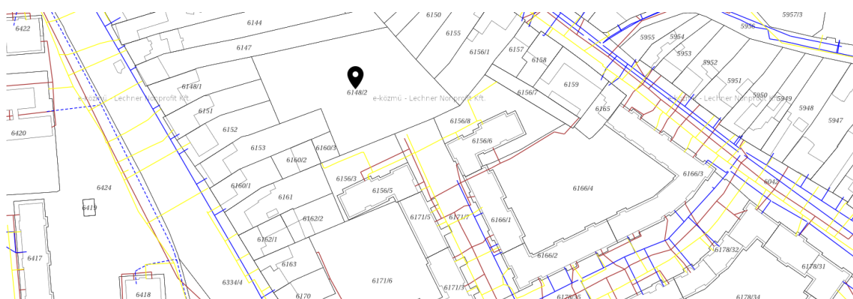
5. ábra: Közműtérkép: szénhidrogén, vízellátás, vízvezeték (forrás: E-közmű)
