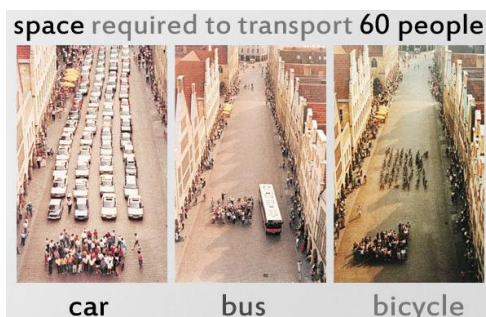
3. ábra: Az ábra jól szemlélteti, hogy a gépjármű közlekedés önmagában jelentős területeket foglal el városainkban (60 ember által elfoglalt terület autó, busz, illetve kerékpár esetén) 9
