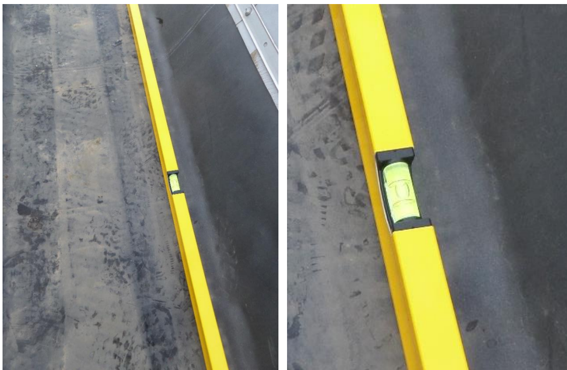
25-26.sz. fotó Az Észak-Keleti hosszoldali következő vápa szakaszon készült EPDM műanyaglemez bélelésű vápa lejtése 0%-1%, ami igen csekély csapadékvíz elfolyást biztosít a lefolyó irányába.
